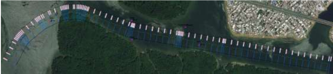
Figura 7-10 Nueva realineación del canal de 3 bocas
