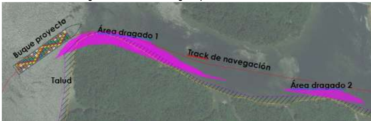
Figura 7-11 Maniobra de ingreso por la Perimetral Marítima
