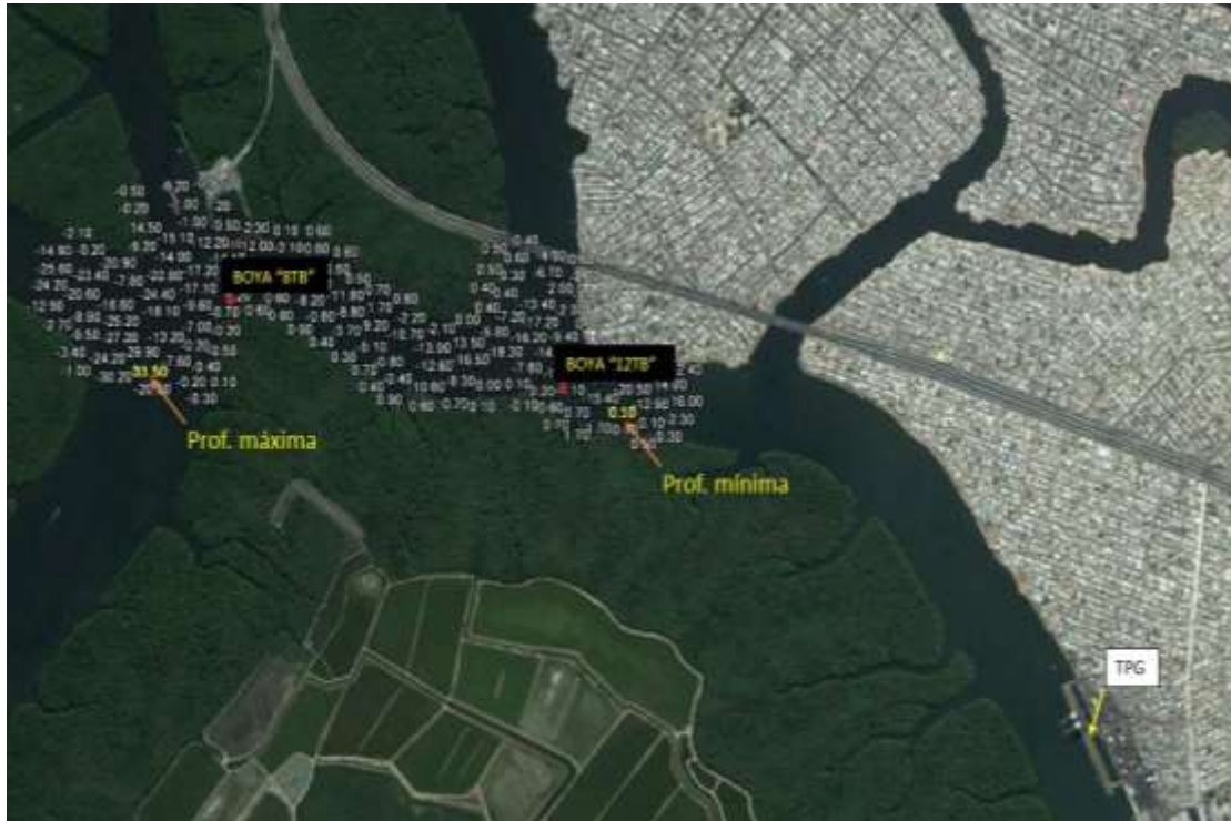
Figura 7-3 Profundidades reflejadas del levantamiento Batimétrico en el área comprendida entre Tres Bocas (BOYA "8TB") y área de giro (BOYA "12TB")
